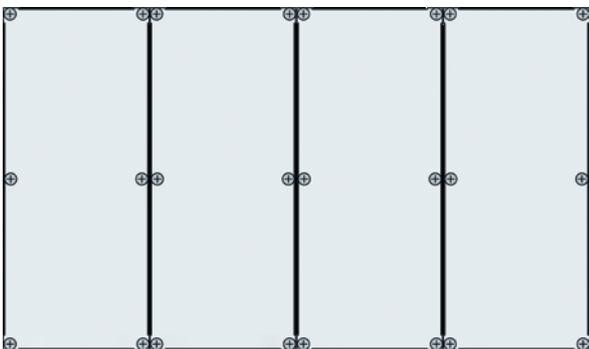
Dans le cas d'ensemble sur une seule rangée, le bas des coffrets doit se situer à une hauteur comprise entre 1 m et 1,20 m du sol fini.
