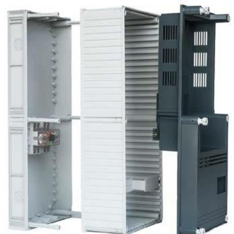
Afin de pouvoir alimenter chaque compteur avec le câble de raccordement, un bloc de raccordement doit être installé dans un des coffrets 25D60. Si la section du câble d'alimentation désignée par le REW est supérieure ou égale à 50 mm<sup>2</sup>, l'ensemble de comptage doit être équipé d'un coffret réducteur 25S60 pour deux entrées de 150 mm<sup>2</sup>.
