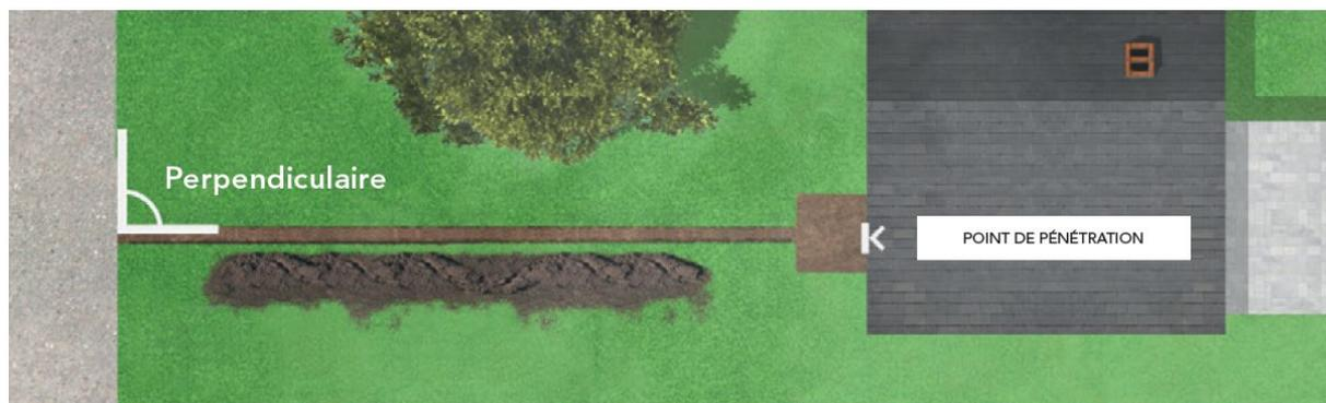
Un puits de 1 m x 1 m en surface et de 1,2 m de profondeur doit être réalisé à l'endroit où le branchement va entrer dans le bâtiment pour permettre la manipulation des câbles ou des conduites par nos techniciens. Il servira également à interrompre les gaines venant de l'extérieur afin d'éviter toute pénétration d'humidité ou de gaz dans le bâtiment.
